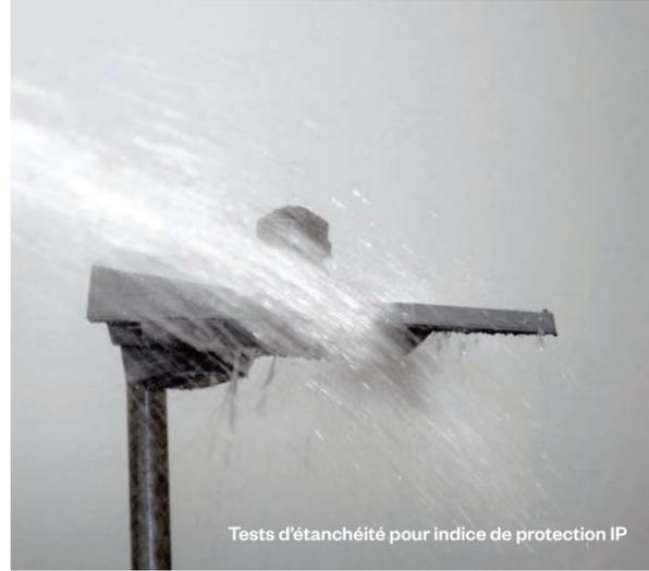
Tests d'étanchéité pour indice de protection IP
